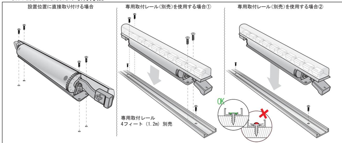
・最初のeW Fuse Powercoreの取付位置を決め、灯具のオスコネクターに専用リードケーブル(別売)のコネクターを接続します。反対側のメスコネクターに次の灯具を接続します。この手順を繰り返すすべての灯具を取り付けます。配線状況により専用ジャンパーケーブルを灯具間に接続します。
