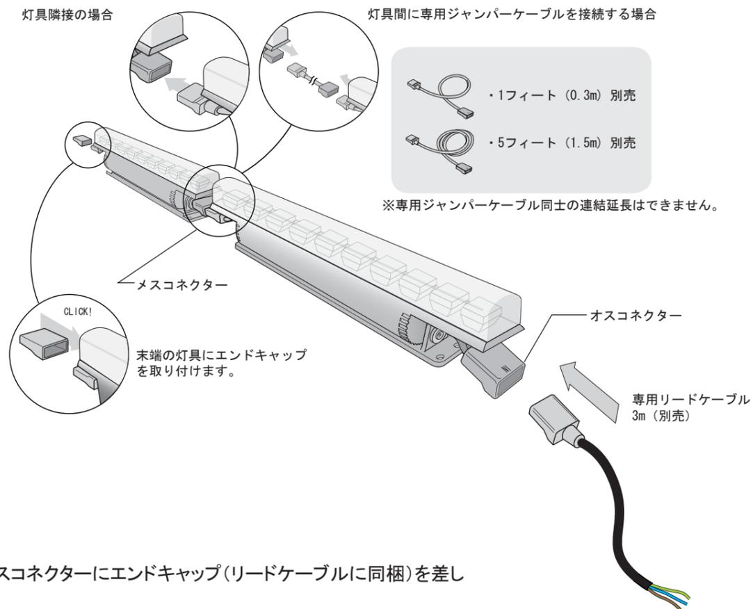
・末端灯具のメスコネクターにエンドキャップ(リードケーブルに同梱)を差し込みます。
